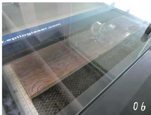
レーザー加工機を使用し、青海波を描く
