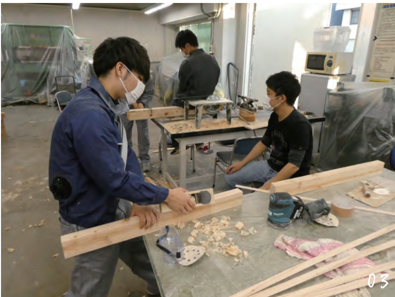
カットした木材をカンナやサンダを使って研磨する 充電式ランダムオービットサンダ BO140DRF
