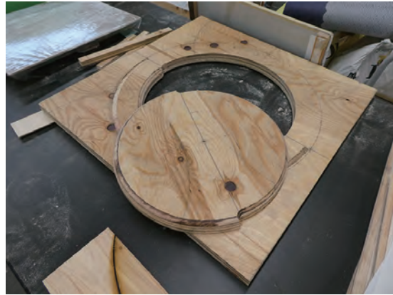
青海波の型枠作り（試作）
