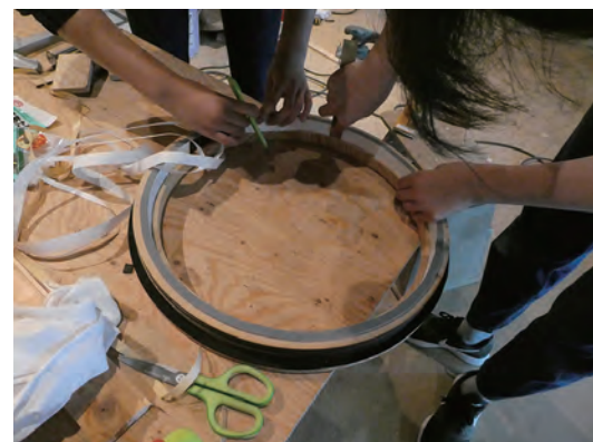
明り取り窓の仕上げ
