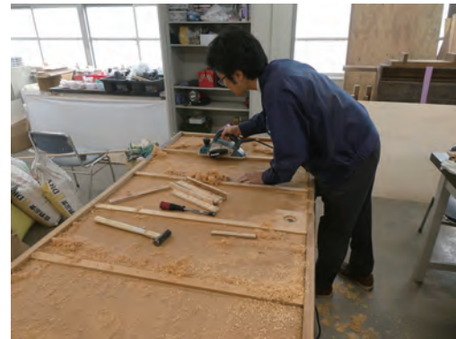
襖の骨の部分を電動カンナで削る
