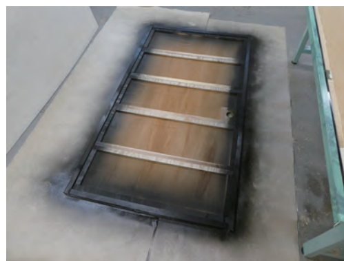
枠を黒色のスプレーで吹き付ける
