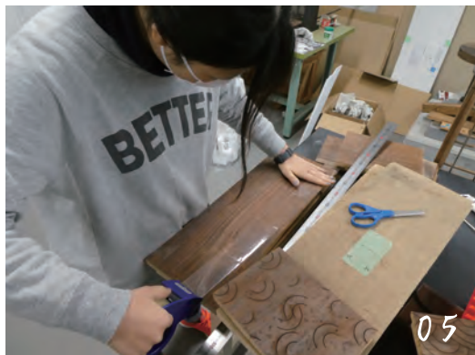
カットした床材に透明テープを貼る
