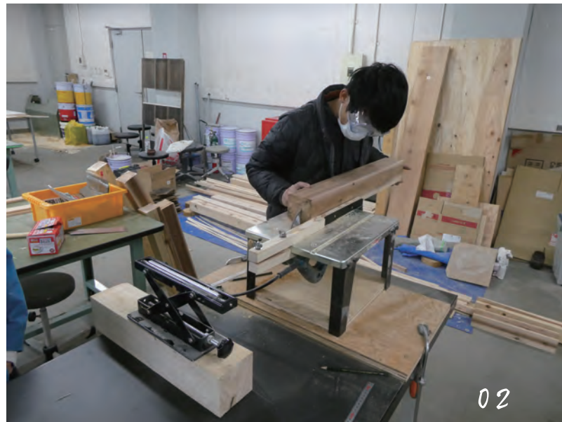
手すり子の幅にカットしていく
